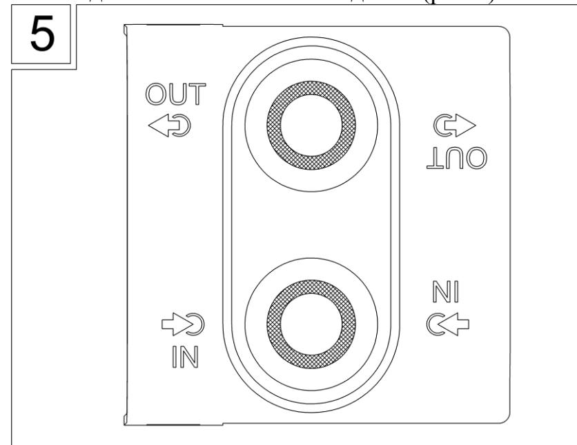
При монтаже применяйте резиновые шланги и патрубки входящие в комплект поставки. Шланги следует прокладывать без заломов и по возможности с подъемом от подогревателя для беспрепятственного удаления воздуха. При прокладке шлангов не устанавливать их рядом с выхлопной трубой и элементами двигателя, которые имеют высокую температуру нагрева.
